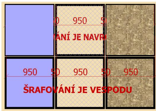
V horní části jsou šrafy navrchu a překrývají nejen kótu a text, ale i část tlusté obvodové čáry. V dolní části jsou šrafy přesunuty dozadu a vše je čitelné.
