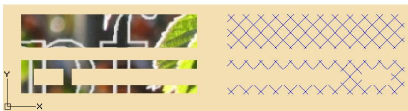
Pokud použijete na šrafování obrázek (bitmapu), tak můžete těmito příkazy odříznou či vyříznout část obrázku! A tak nezapomeňte, že od verze 12 můžete vzorek šrafy (i když jej tvorí obrázek) posouvat! Je to velmi silný prostředek, který například AutoCAD neumí.
